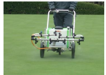
散布幅 1m での作業
